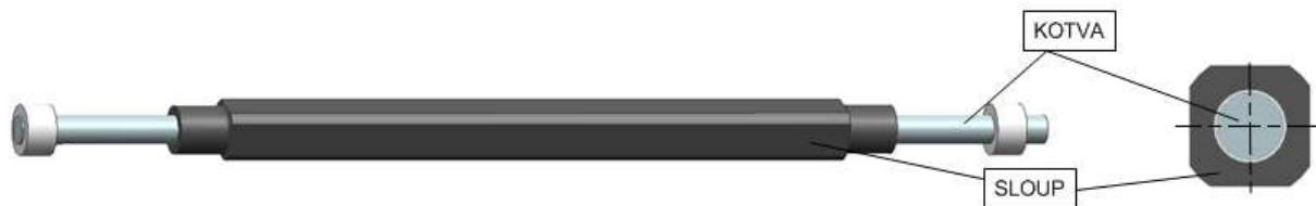
Obr. 2 Rozpěrné tělo sloupu a průřezová charakteristika
