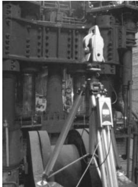
Obr.7 Ukázka praktického měření deformace rámu lisu
